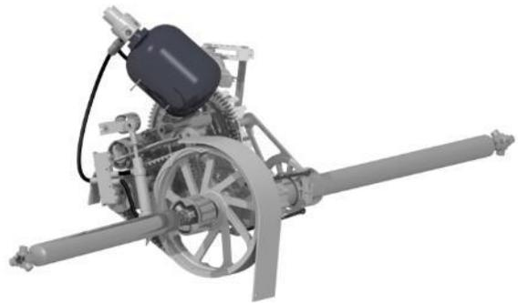
Das Lamellensperrdifferential mit nur einem Bolzen ermöglicht eine schnelle Anpassung der Einstellungen an die unterschiedlichen Rennstrecken. Jede Einstellung unterscheidet zwischen 5 Fahrzuständen: Starke Beschleunigung, mittlere Beschleunigung, Schleppbetrieb, leichtes Bremsen, starkes Bremsen. Dadurch kann in jeder Fahrsituation die optimale Sperrwirkung eingestellt werden. Außerdem verbessert dieses Differential die Traktion am Kurvenausgang bei gleichzeitig erhöhter Agilität in der Kurve.
