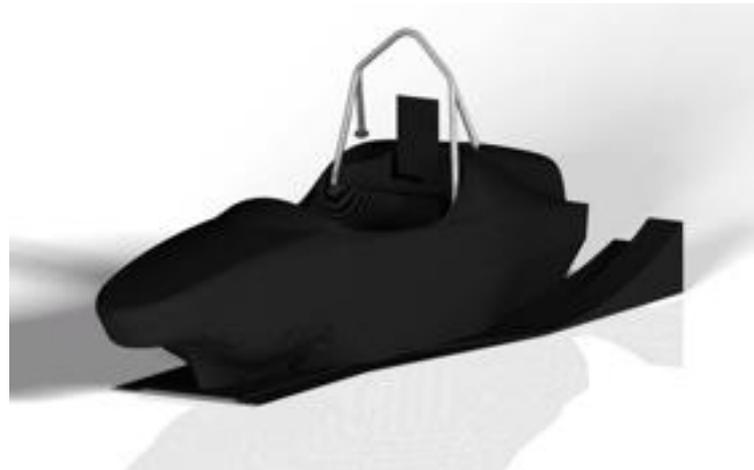
fahrzeug. Dadurch entstand ein neues kompromissloses Chassis-Design, welches durch ein radikales Konzept, bestehend aus einem durchgängigen geschlossenen Hohlprofil besteht. Davon versprechen wir uns eine enorm gesteigerte Torsionssteifigkeit bei zugleich reduziertem Gewicht.
